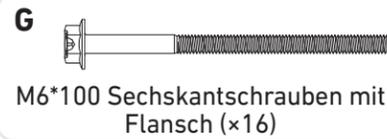
M6\*100 Sechskantschrauben mit Flansch (x16)
